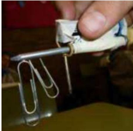
Enrollamos el cable alrededor del clavo y lo conectamos a los polos de la pila, como se ve en la figura. Por acción de la electricidad que circula en el cable, el clavo se convertirá en un imán que puede atraer pequeños y livianos objetos que contengan hierro.
